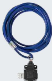
Interruttore con fune Possibilità di montaggio orizzontale o verticale, custodia in alluminio pressofuso, IP 65, lunghezza fune 4 m
